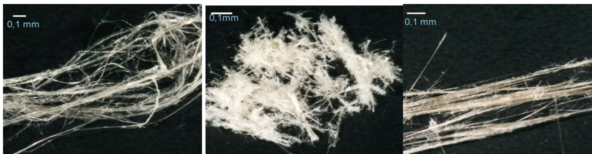
Rys. 1. Długowłóknisty azbest chryzotylowy praktycznie nie zawierający zanieczyszczeń (a), chryzotylowy azbest krótkowłóknisty zanieczyszczony talkiem (b) i azbest amozytowy (c) 6
